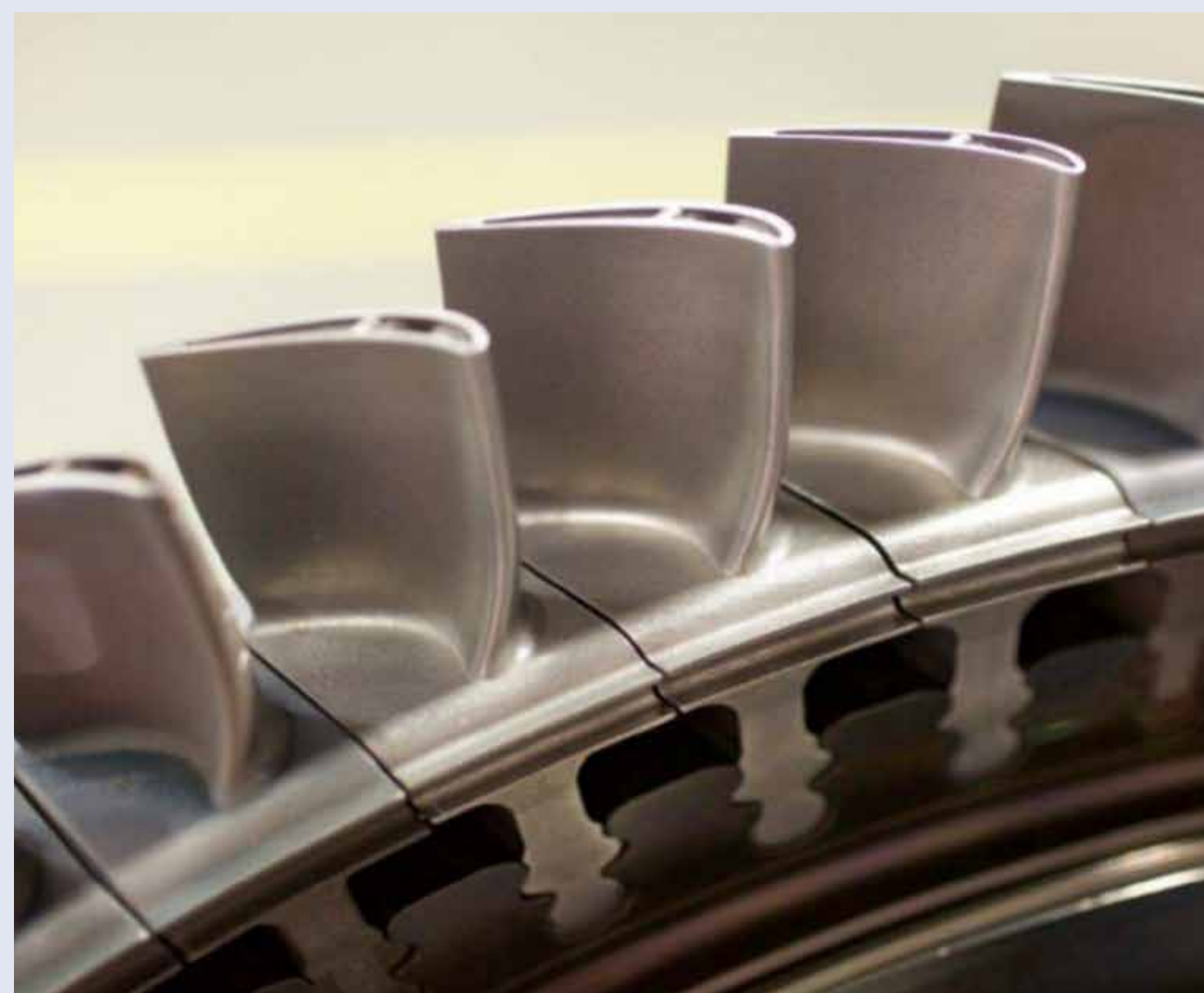
Pás de turbinas
