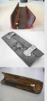
Um dos maiores desafios para a produção eficiente é o desgaste prematuro de peças. Equipamentos que operam em contato constante com partículas sólidas — como plantadeiras em solos arenosos ou colheitadeiras de arroz — estão sujeitos a intensos processos de abrasão, corrosão e erosão. Esse desgaste severo resulta em uma queda significativa de produtividade e exige paradas frequentes para a substituição de peças, impactando diretamente o desempenho e a eficiência operacional.
