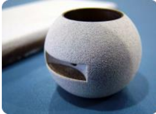
Figura 2: Revestimento cerâmico aplicado por aspersão térmica válvulas de esferas
