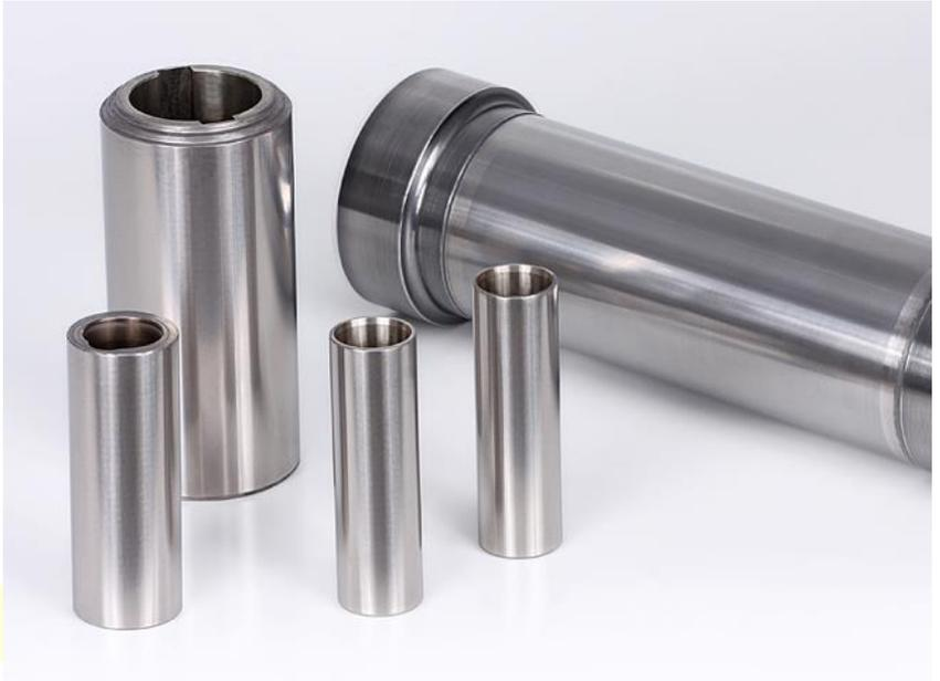
Bombas de polpa são vedadas com gaxetas e possuem desgaste acentuado no eixo na região de vedação. A gaxeta é abrasiva e acaba gastando o eixo e gerando vazamento no equipamento. Para o eixo não ser perdido uma luva de desgaste é utilizada. Normalmente essas luvas são fabricadas em aço inoxidável.
