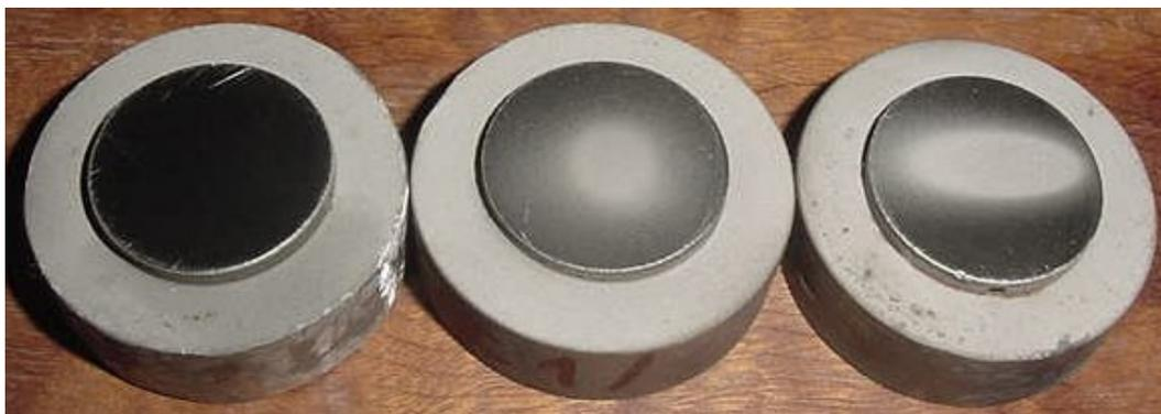
Figura 4.6. Amostras de  $\text{Cr}_2\text{C}_3\text{-NiCr}$  (a) antes do desgaste, (b) após o desgaste em  $90^\circ$ , (c) após o desgaste em  $30^\circ$ .
