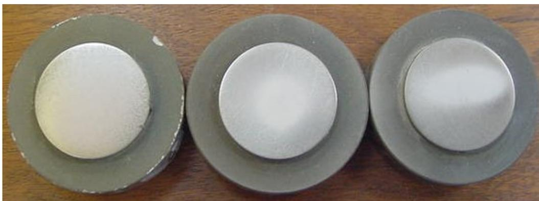
Figura 4.8. Amostras de WC-12Co (a) antes do desgaste, (b) após o desgaste em 90°, (c) após o desgaste em 30°.
