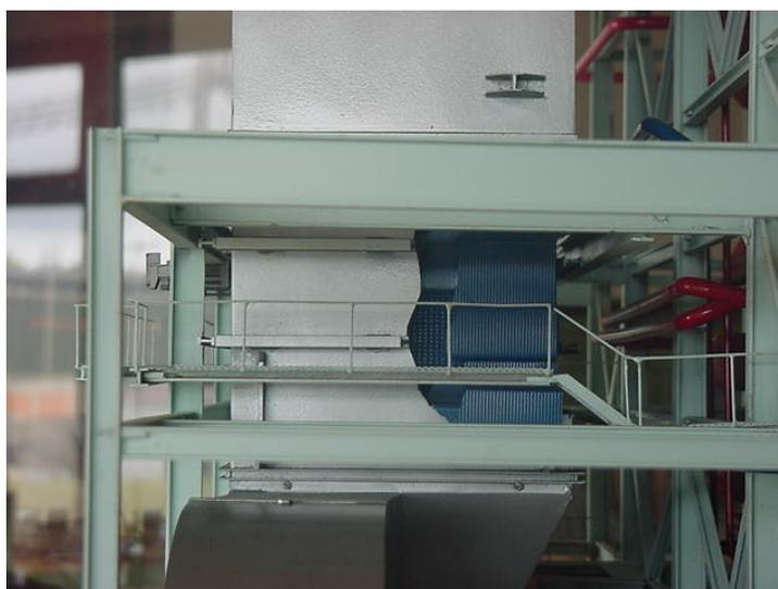
Figura 2.3. Vista lateral do economizador, em corte, mostrando em detalhe os tubos do trocador de calor (Maquete da sala de Visitaç o – CGTEE Candiota).
