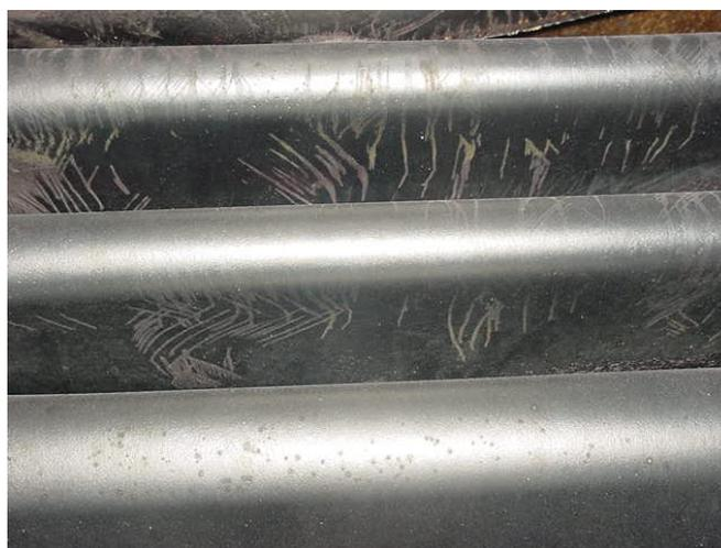
Figura 2.6: Detalhe da erosão nas chapas próximas à parede falsa (CGTEE – Candiota).
