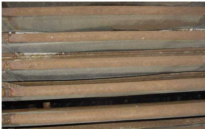
Figura 2.7: Detalhe da corrosão nos tubos centrais do Economizador 1 (CGTEE – Candiota).
