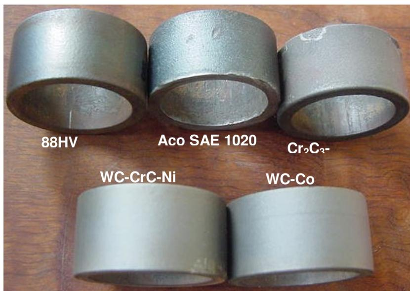
Figura 4.12. Anéis retirados do Economizador 4 após 28 dias de exposição ao desgaste da cinza.
