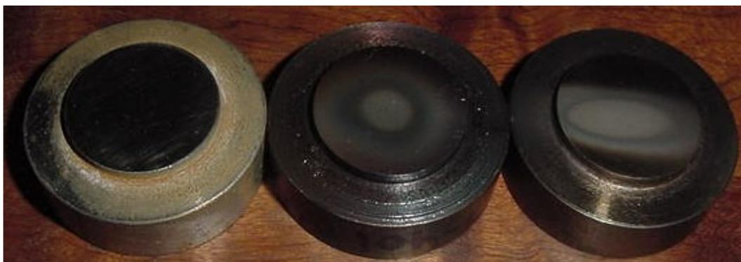
Figura 4.5. Amostras de aço (a) antes do desgaste, (b) após o desgaste em  $90^\circ$ , (c) após o desgaste em  $30^\circ$ .
