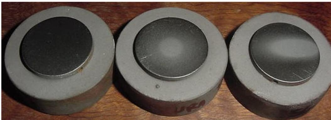
Figura 4.7. Amostras de WC-CrC-Ni (a) antes do desgaste, (b) após o desgaste em 90°, (c) após o desgaste em 30°.
