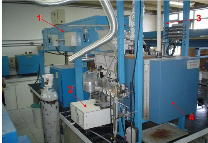
Figura 8 - Equipamento para ensaios de desgaste erosivo indicando as partes principais: (1) Pré-aquecimento do ar; (2) Sistema de alimentação das partículas erodentes; (3) Sistema venturi-acelerador de partículas; (4) Forno para os ensaios (LACER/UFRGS).
