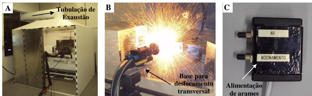
Figura 7 - (a) Cabine de aspersão; (b) Sistema de aplicação semi-automático; (c) Controle remoto de acionamento.
