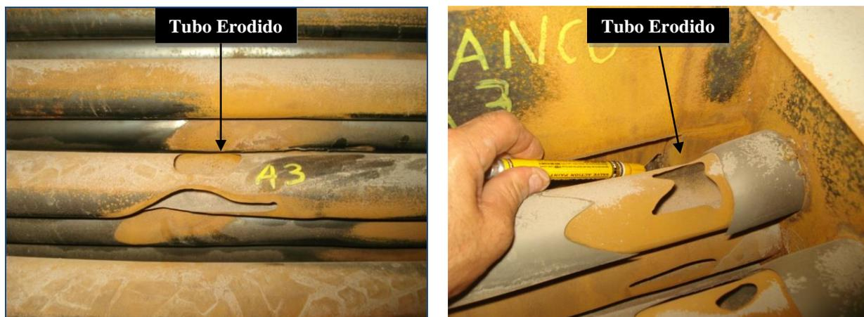
Figura 2 - Tubo do aquecedor tubular que sofreu desgaste por erosão.
