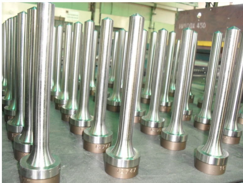
FIGURA 11: Corpos de prova – peças cilíndricas mais complexas Fonte: Fotografado pelo autor, 2010.
