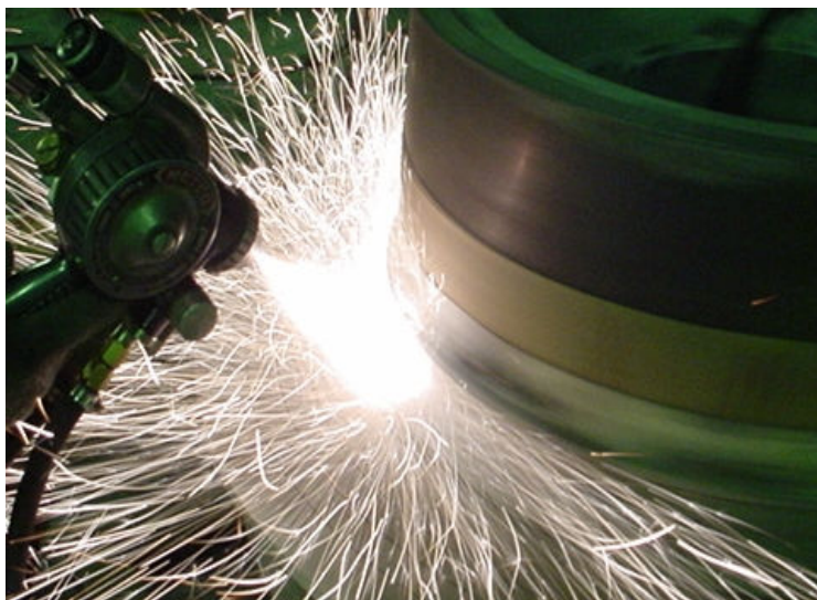
FIGURA 14: Equipamento processo aspersão térmica
