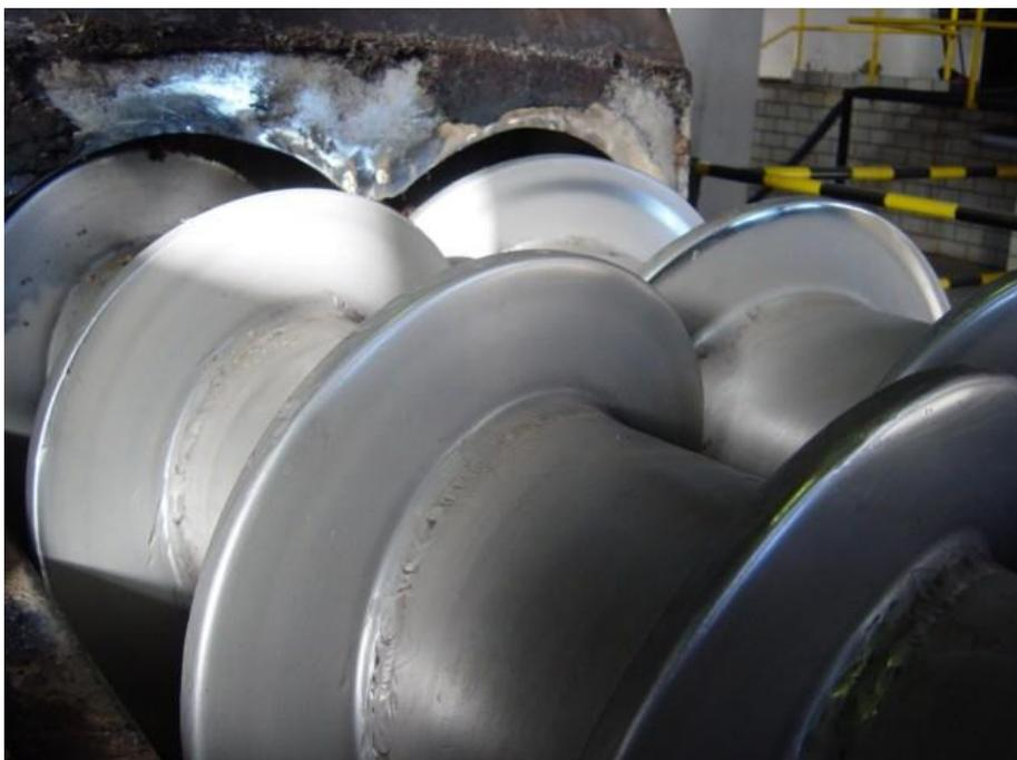
Revestimentos de Carboneto de Tungstênio garantem a maior vida útil de roscas transportadoras em mais de 300%. Além disso melhoram o desempenho do equipamento devido ao menor coeficiente de atrido entre a superfície da peça e o material transportado
