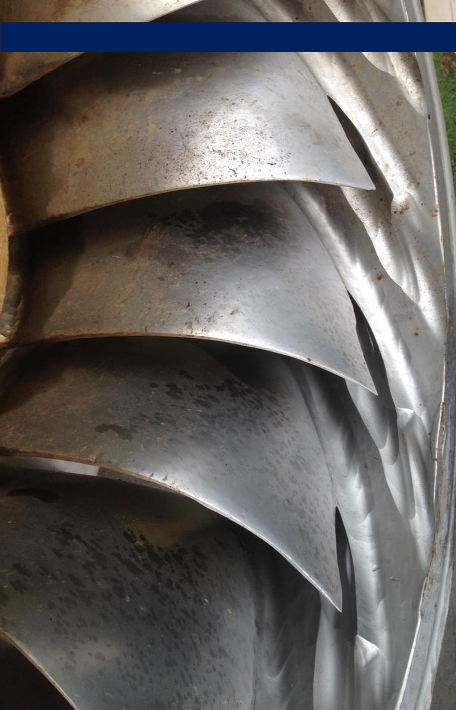
A liga possui **dureza superior a 1000 HV300**, possui elevadíssima resistência ao Desgaste por Erosão, e pode incrementar a vida útil de um rotor em mais de 300%.
