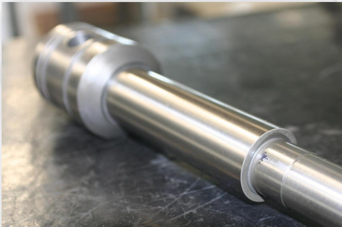
Aplicação de revestimento de carboneto de tungstênio nas regiões de vedação.
