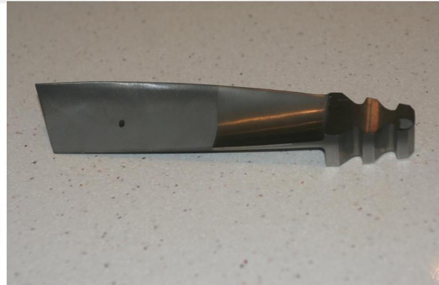
Aplicação de metal compósito em Pás de turbinas de condensação
