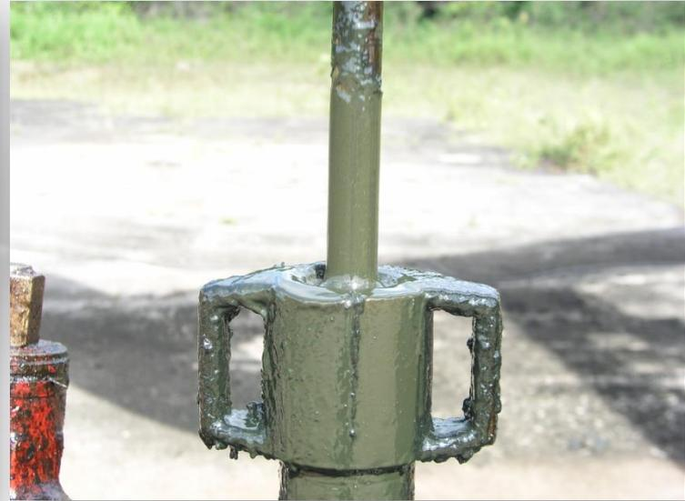
Hastes Polidas com carboneto de tungstênio para resistir à abrasão.
