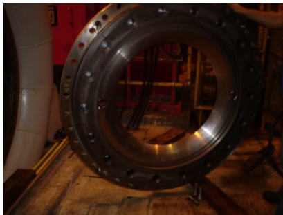
Tampa da turbina lado sucção revestida com carboneto de tungstênio.
