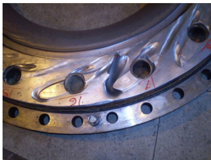
Desgaste erosivo na tampa de fechamento
