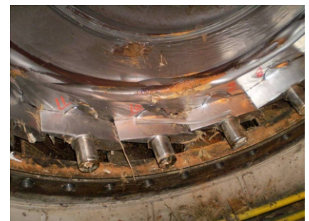
Desgaste erosivo em pás diretrizes
