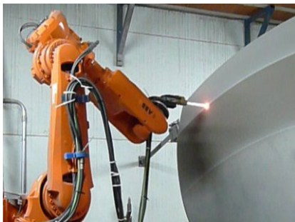
Aplicação de revestimento robotizada.
