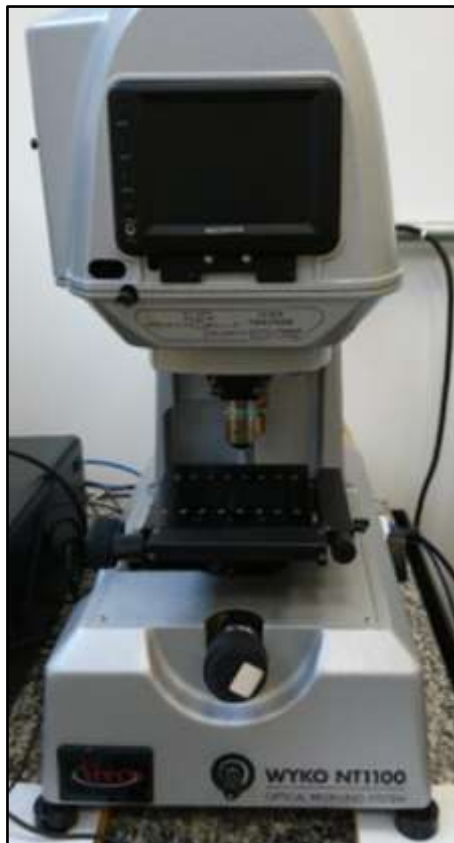
Figura 42 – Perfilômetro Veeco NT1100 ( Optical Profiling System )
