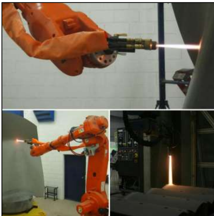
Figura 32 – Revestimento por aspersão térmica HVOF
