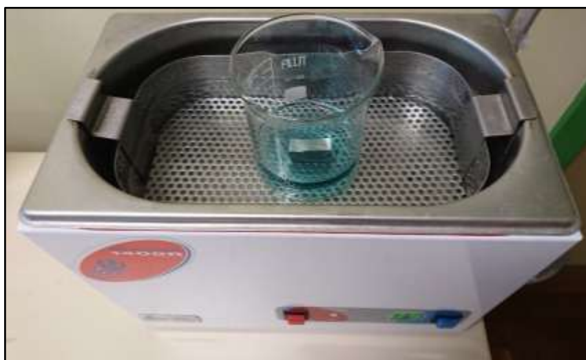
Figura 41 – Aparelho de limpeza por vibração ultrassônica
