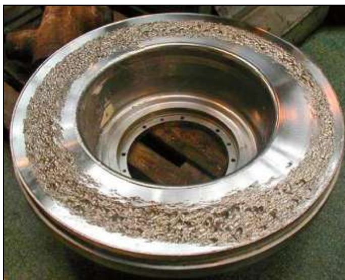
Figura 10 – Aceleração do desgaste erosivo em bombas submetida a sólidos suspensos.
