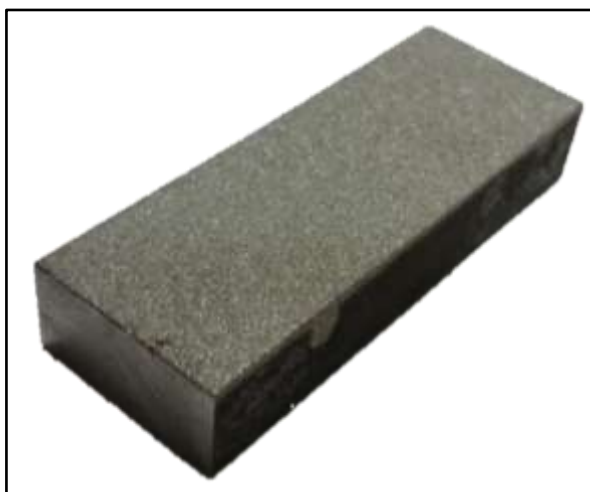
Figura 30 – Superfície jateada com granalha de alumina
