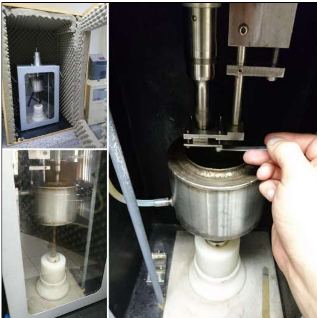
Figura 50 – Ajuste dos Parâmetros. Equipamento de Cavitação (Laboratório de Metalografia/UTFPR – Ponta Grossa)
