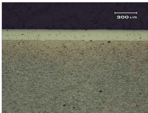
Figura 2: Imagem em MO da amostra da chapa identificada como 1, tamanho médio de camada de 95,9 μm.
