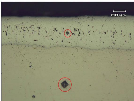
**Figura 20: Imagens em MO da amostra identificada como superior com menor desgaste, com as identações feitas destacadas pelo círculo.**
