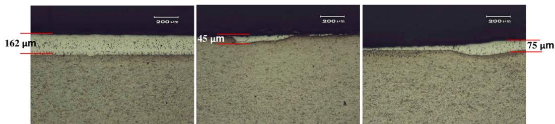
Figura 12: Imagens em MO da amostra identificada como inferior com menor desgaste, apresentando variação na espessura média da camada, à esquerda 162  $\mu\text{m}$ , ao centro 45  $\mu\text{m}$  e à direita 75  $\mu\text{m}$ .
