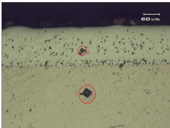
**Figura 18: Imagens em MO da amostra identificada como inferior com menor desgaste, com as identações feitas destacadas pelo círculo.**
