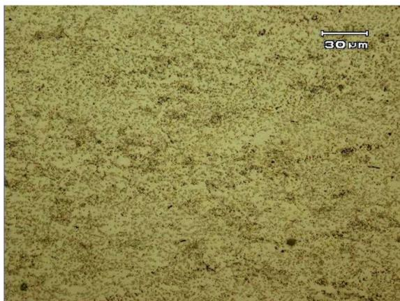
Figura 10: Imagem em MO da amostra inferior com maior desgaste, mostrando material no estado não temperado.
