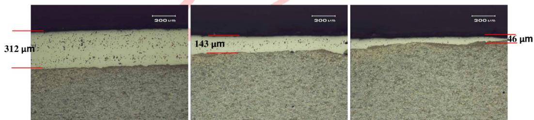
Figura 14: Imagens em MO da amostra identificada como superior com menor desgaste, apresentando variação na espessura média da camada, à esquerda 312  $\mu\text{m}$ , ao centro 143  $\mu\text{m}$  e à direita 46  $\mu\text{m}$ .
