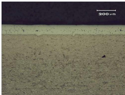
Figura 3: Imagem em MO da amostra da chapa identificada como 2, tamanho médio de camada de 107,2 μm.
