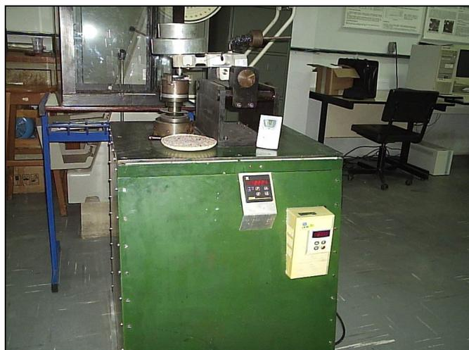
**Figura 35** – Tribômetro pino sobre disco da FITEJ de Joinville.
