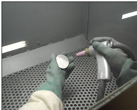
**Figura 29** – Jateamento com abrasivo óxido de alumínio em cabine de jateamento manual.
