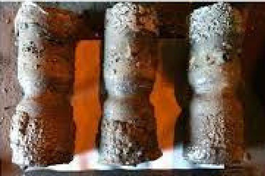
Ocorre quando partículas sólidas dispersas em um fluido impactam na superfície de um material, removendo-o.
