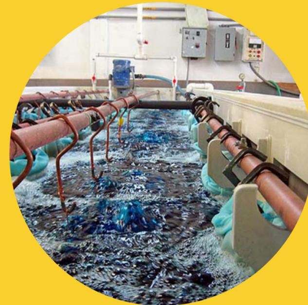
Camada superficial de cromo metálico depositado por galvanoplastia (deposição eletrolítica)
