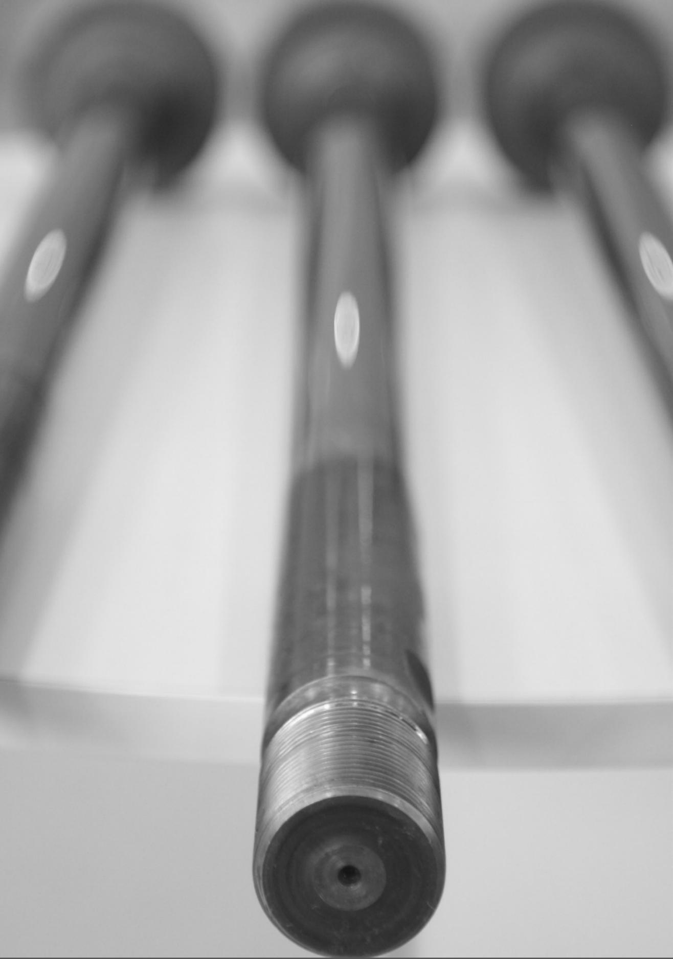
**Tanto o Cromo Duro como o Carboneto de Cromo proporcionam elevada resistência ao desgaste à abrasão, mas já vimos que a resistência à corrosão do Carboneto de Cromo é bem superior e estas propriedades são mantidas mesmo em temperaturas elevadas.**
