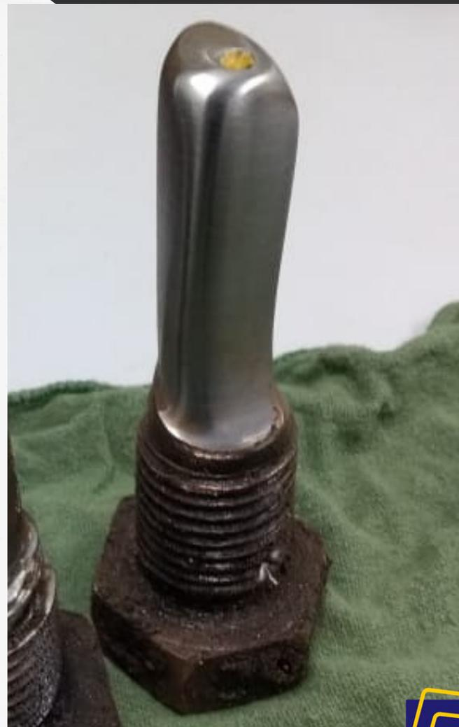
Desgaste nos parafusos originais após 30 dias de uso
