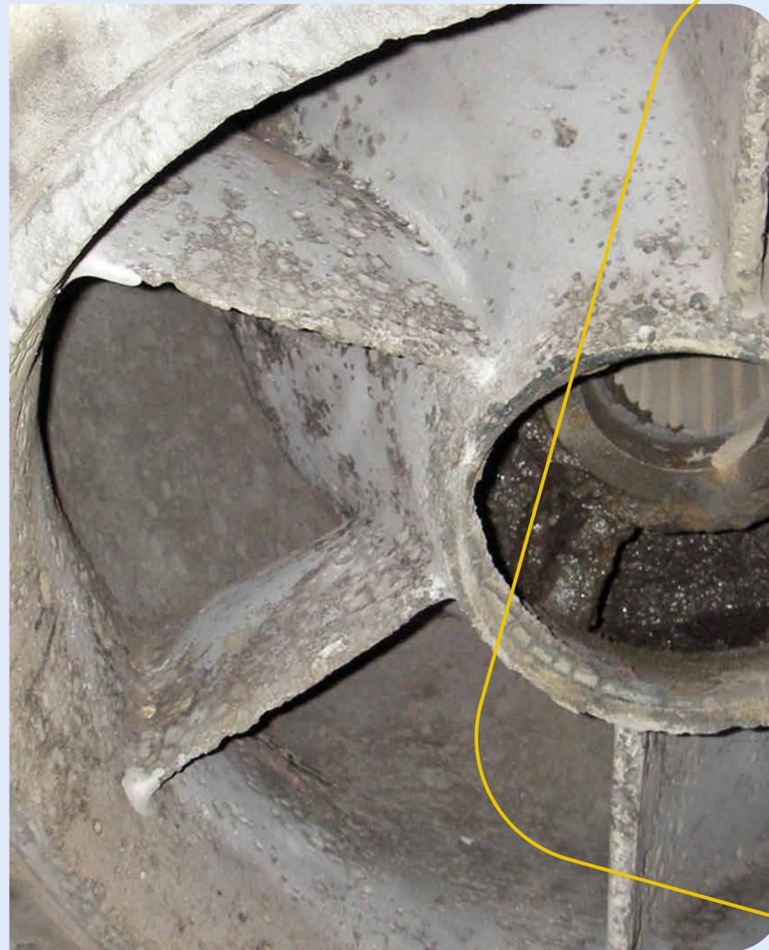
Mecanismos de desgaste em bombas de polpa
