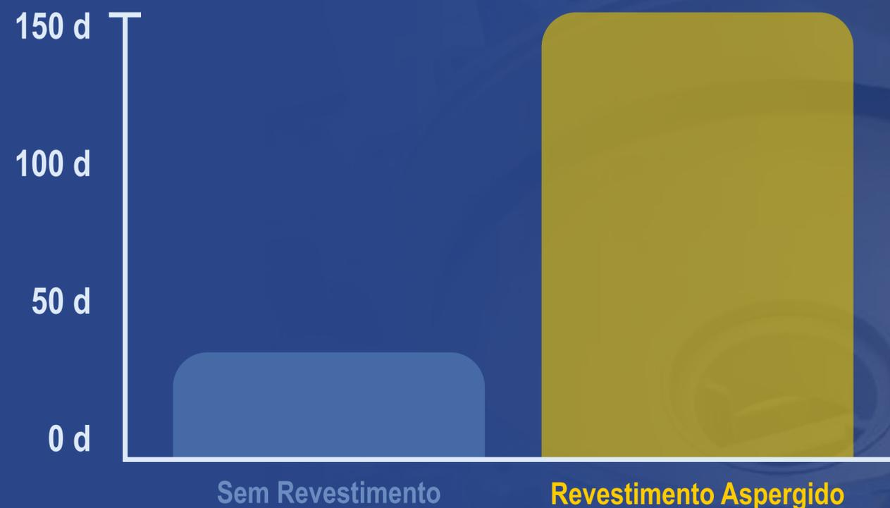
A aplicação de Carboneto de Tungstênio, revestimento de alta dureza e eleva resistência à abrasão e erosão, promoveu um acréscimo de 400% na vida útil da voluta de uma bomba de exploração de níquel.
