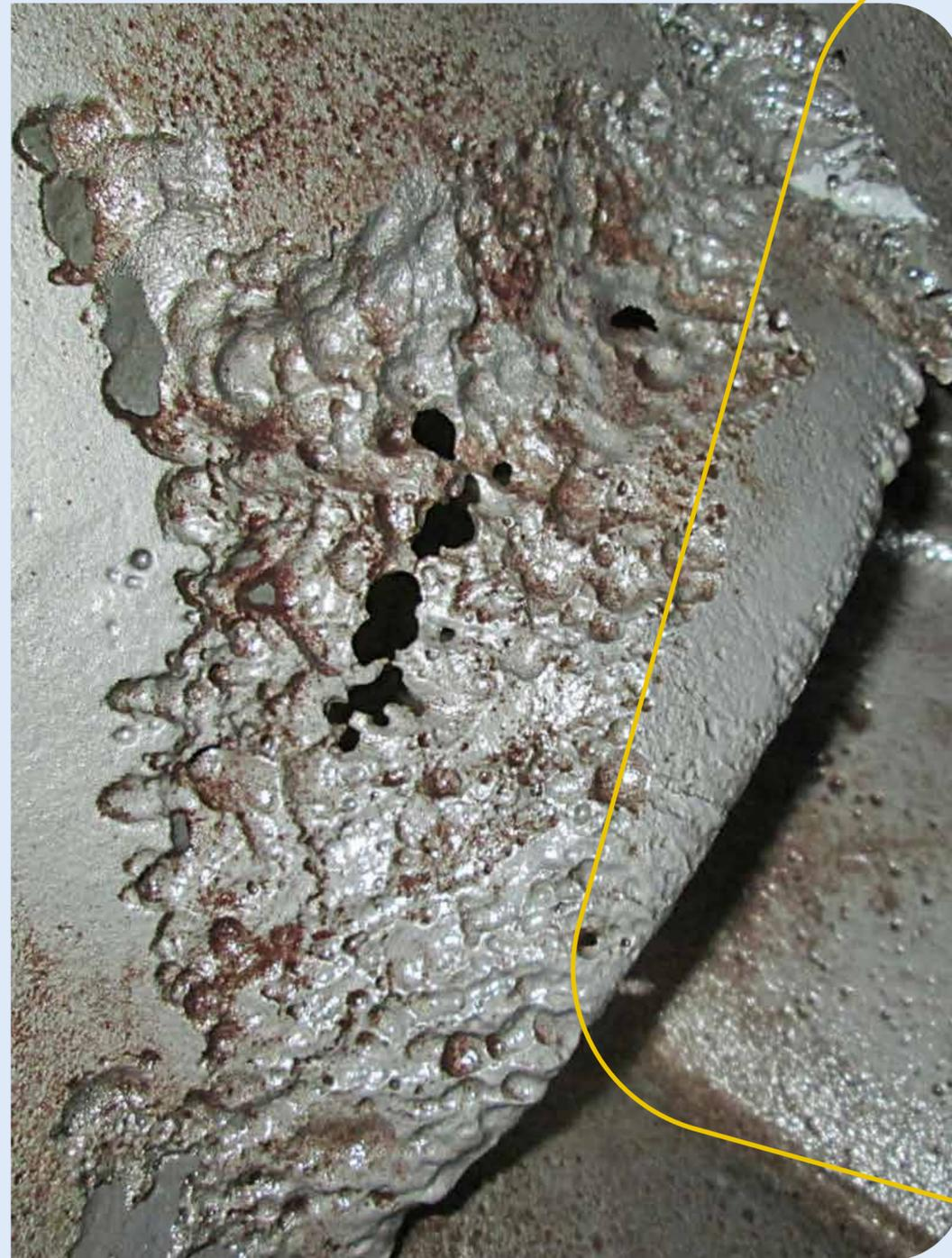
Mecanismos de desgaste em bombas de polpa
