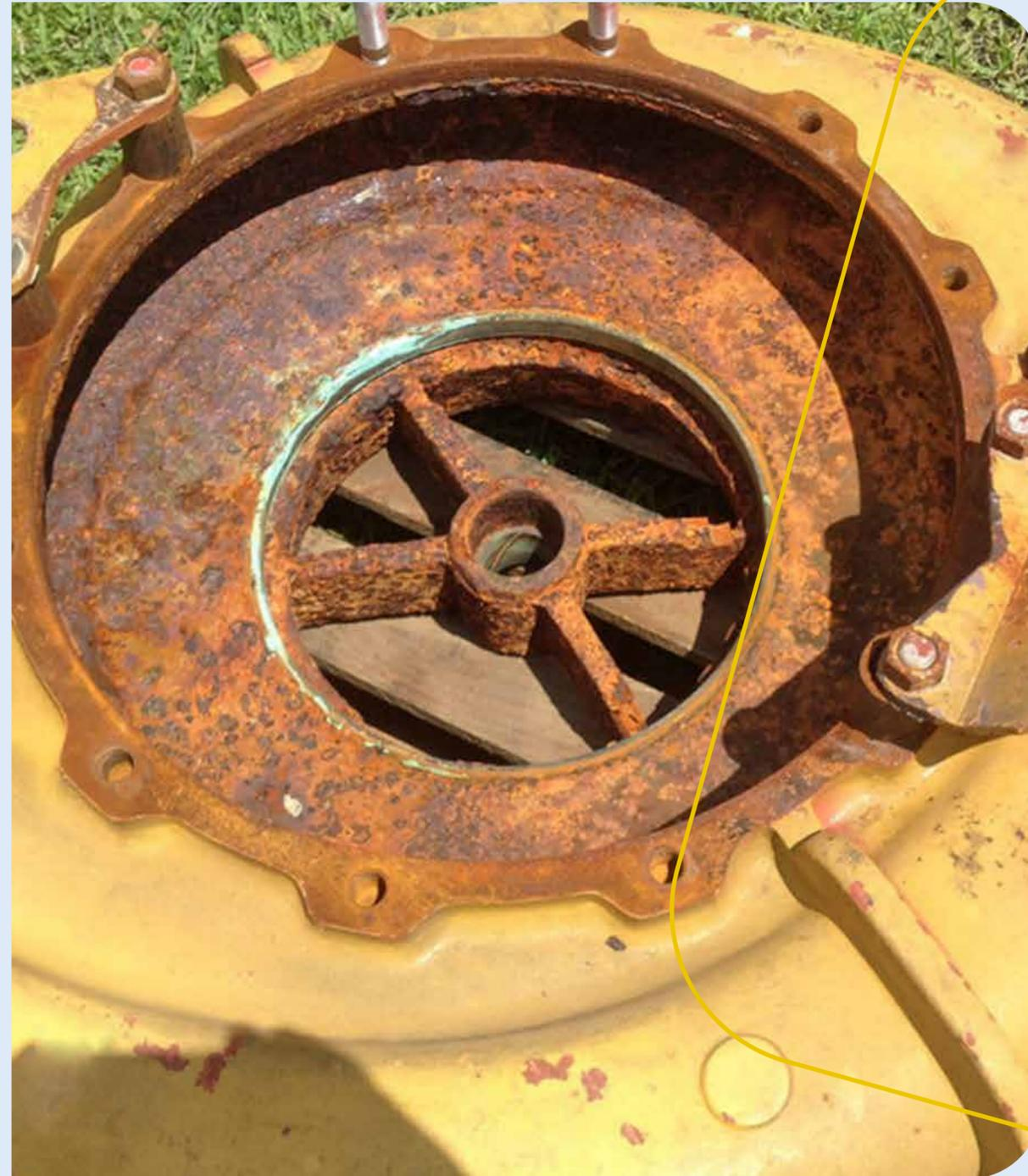
Mecanismos de desgaste em bombas de polpa
