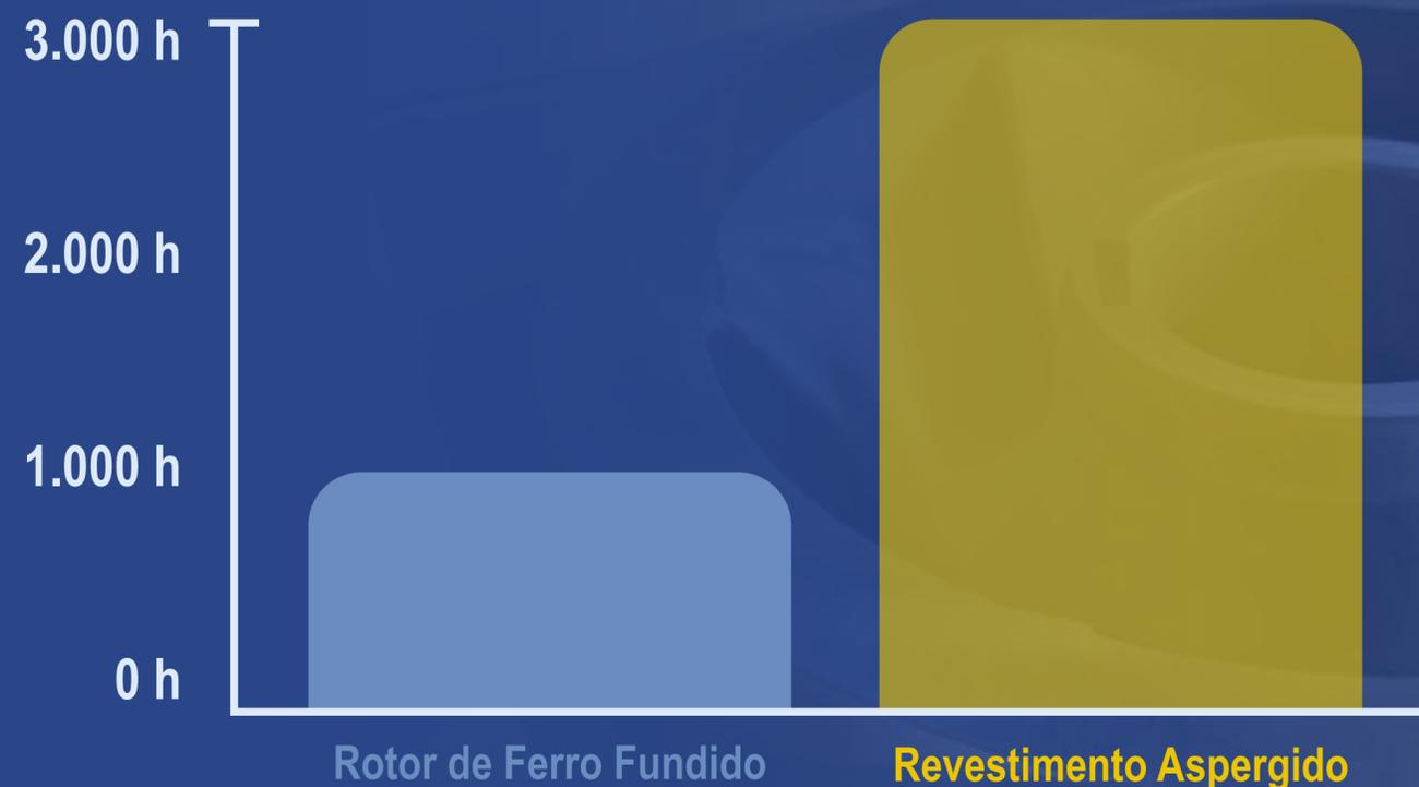
Previamente à aplicação de revestimentos, o rotor de uma bomba de processamento de minério de ferro, registrava perda de eficiência de produção devido ao desgaste erosivo e corrosivo após 1000h de operação. Após a aplicação, o rotor passou a operar por mais de 3000h com eficiência máxima.
