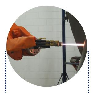
Processo de aplicação todo robotizado, controlado e rastreado para garantir total conformidade com a especificação técnica.
