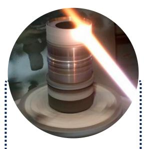
Os revestimentos contra desgastes aplicados pela Rijeza podem ser metálicos e cerâmicos. São aplicados através da tecnologia de Aspersão Térmica que garantem estrutura lamelar, porosidade inferior a 1%, adesão superior a 70 MPa e altíssima resistência a desgastes abrasivos, corrosivos e erosivos.
